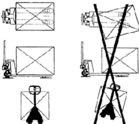
Груз должен располагаться так, чтобы вес равномерно распределялся на обе вилы.
