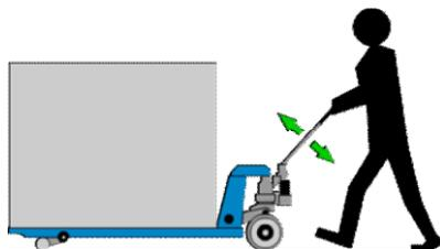
Груз поднимается при движении ручки гидравлической тележки.
